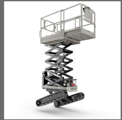
BIBI, mini-scissor cingolato in grado di operare ad altezze di 8 metri. La trazione cingolata permette di superare tutti i limiti della tradizionale trazione 4x4 garantendo la possibilità di operare in spazi ridotti. Il livellamento automatico della piattaforma, permette di operare con assoluta semplicità e sicurezza anche in condizioni di forte pendenza o terreni accidentati. La doppia motorizzazione, a scoppio ed elettrica, offre assoluta versatilità di impiego, all'esterno come all'interno
