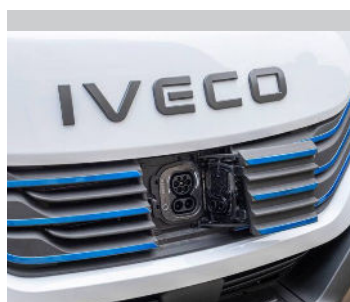
Nem adgang til ladestikket placeret foran
