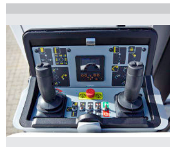
FPC (Fuldprop. CANbus-styring): Variabelt udlæg (med vejecelle) og op til 4 funktioner ad gangen (2 per joystick)
