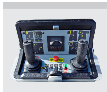
FPC (Fuldprop. CANbus-styring): Op til 4 funktioner ad gangen (2 per joystick)
