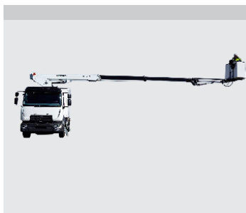
Udsving på drejetårn og støtteben inde for køretøjets sidespejle
