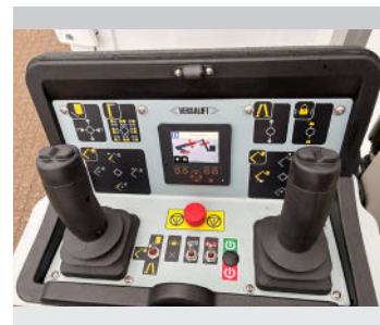
LMC (Load Moment Controls): Variabelt udlæg og op til 2 funktioner ad gangen (1 per joystick)
